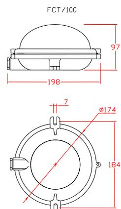
**CUERPO:** Estructura de aleación de Aluminio fundido. Pintura al horno color gris martillado. Instalación eléctrica por medio de 1 salida de 1/2" NPT prensaestopa de bronce.
